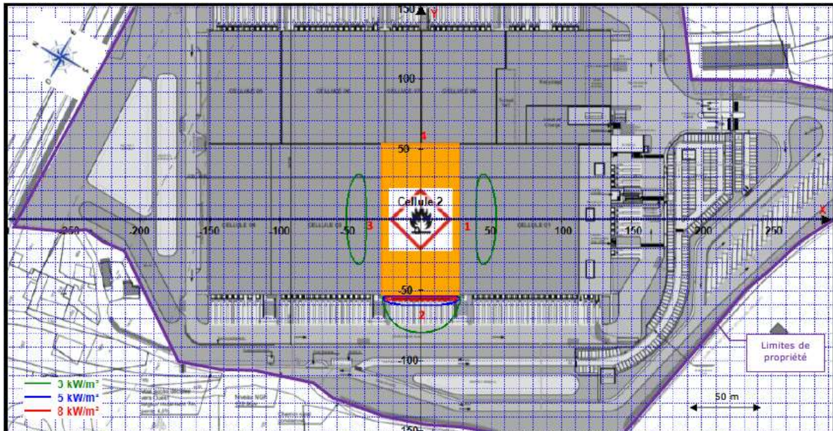
Plan des Flux Thermiques – Cellule 2 – Produits Dangereux – Flumilog (plan masse projet à titre informatif)
